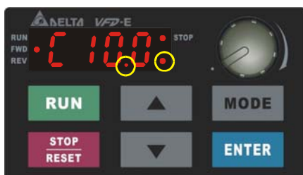
顯示 10000~65535 時，只會顯示前 3 個字元，另外小數點第一位的燈會亮著且右下方 LED 燈會亮起，表示顯示值乘以 100 倍，如圖中所顯示的值表示為 10000~10099
