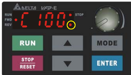
顯示 1000~9999 時，只會顯示前 3 個字元，而且右下方 LED 燈會亮起，表示顯示值乘以 10 倍，如圖中所顯示的值表示為 1000~1009
